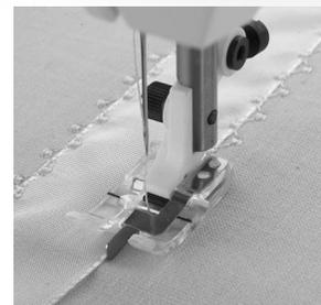
**H-V's new Clear B Edge Joining Foot**
